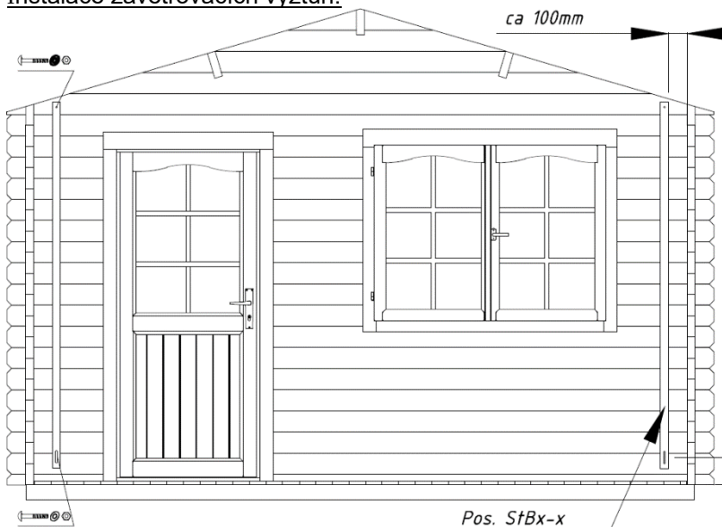
Instalace zavětrovacích výztuh:
